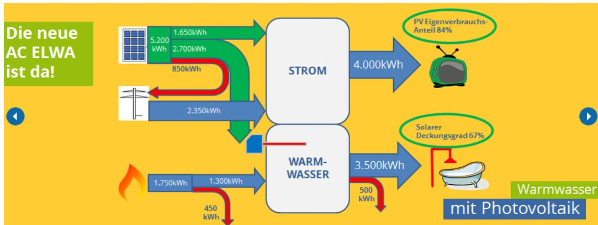
Bei einem 4-Personen Haushalt mit 5kWp PV Anlage werden bis zu 84% Eigenverbrauchs-Anteil erreicht!(Grafik: myPV GmbH)
